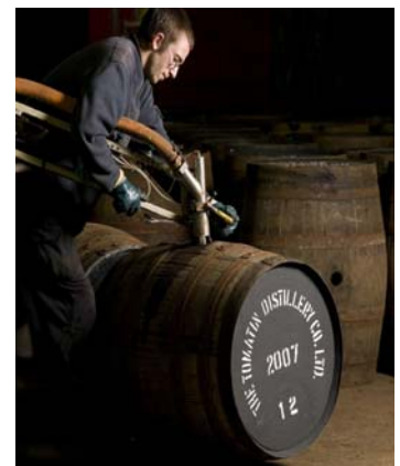
Fassabfüllung des frischen Destillats
